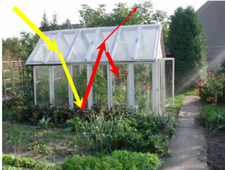
Abbildung 6: Wirkweise eines Treibhauses. Einfallendes Sonnenlicht beleuchtet den Boden und erwärmt ihn. Die resultierende Wärmestrahlung kann das Glas nur schlecht passieren. Sie verbleibt im Treibhaus und heizt es auf ( user:Jürgi-würgi, https://commons.wikimedia.org/wiki/File:Gartengewächshaus.JPG , gemeinfrei).
