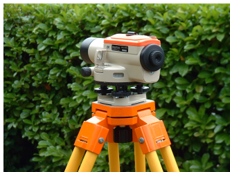
Optisches Nivelliergerät auf Dreibein. Nutzer Clickgauche auf Wikimedia Commons unter Lizenz CC-BY-SA
