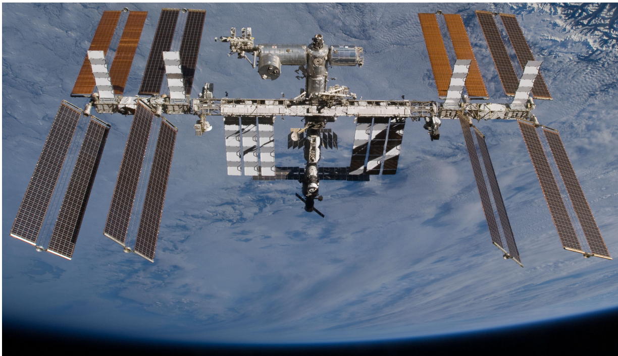
Abbildung 5: Foto der ISS aus dem Jahr 2009. Man erkennt die Solarmodule, die jeweils aus zwei einzelnen Kollektorf lächen bestehen. Die Module drehen sich um ihre Längsachse um sich nach dem Sonnenstand auszurichten (Bild: NASA).
